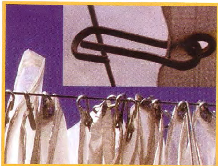
Foto 14.- Primer conector de ojettillo y mosquetón abierto, presenta dificultades para correr.
