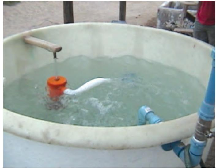
Flotador con sistema de aspiración flotante para prevenir la entrada de suspensión concentrada a la matriz
