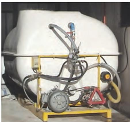
Equipo de inyección de yeso con agitación y bomba inyectora propia
