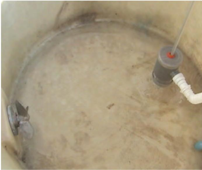
Hélice de agitación del equipo de inyección
