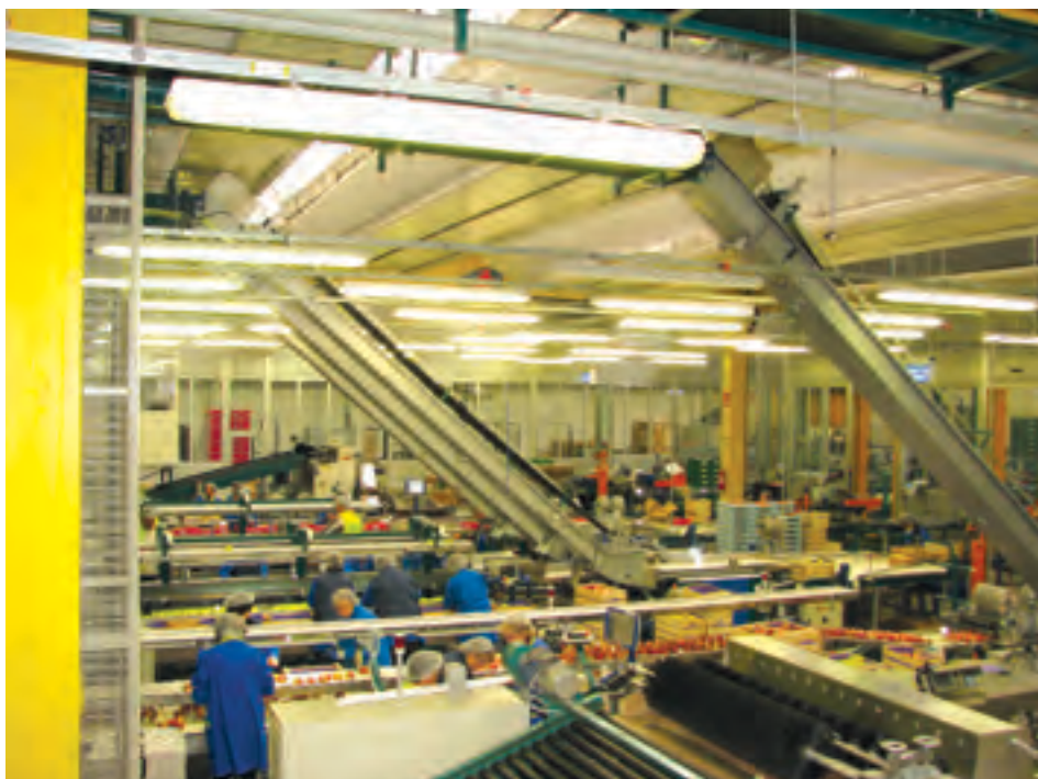
Figura 4. Segunda etapa proceso precalibrado en manzanas.
