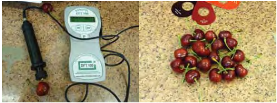
Figuras 6. Instrumento DUROFEL y muestra de frutos para medir firmeza.
