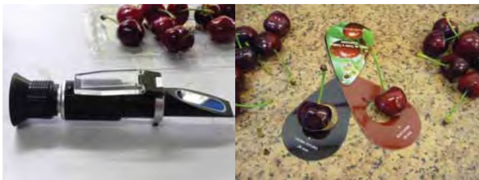
Figura 4. Refractómetro termo compensado ATAGO y tablas de color estandarizadas del laboratorio de post cosecha FAIF-PUC.
