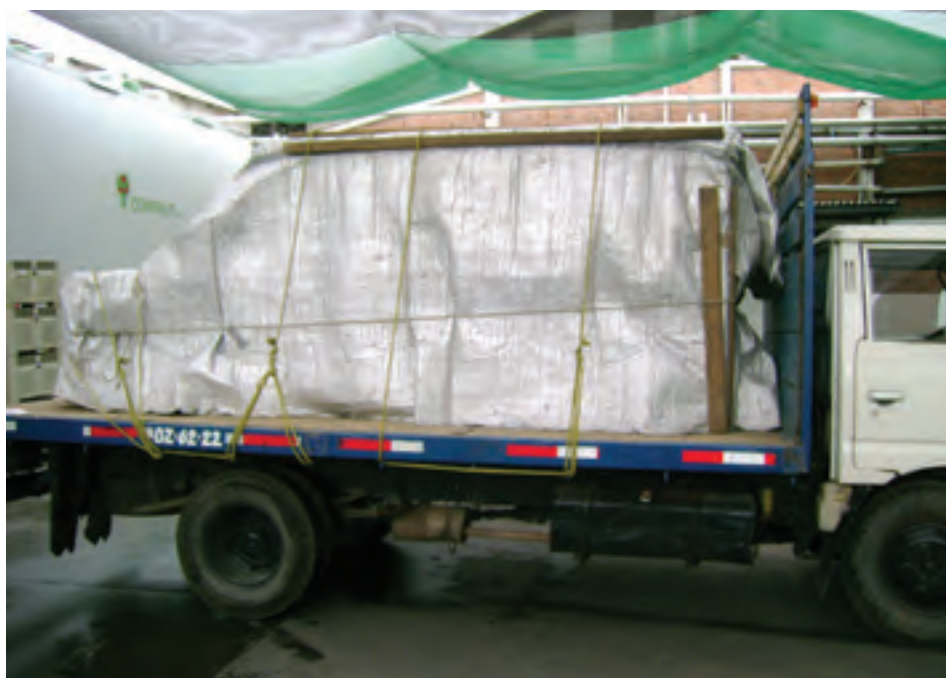
FOTO 8. Correcta protección con carpa reflectante por todos los costados.
