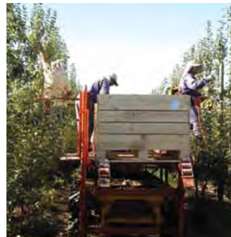
FOTO 8. Plataforma autopropulsada, con piso desplegado lateralmente para cosecha de la parte alta de un huerto de Abate fetel.
