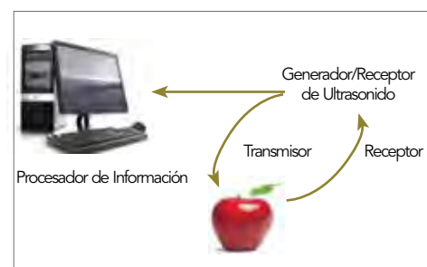
Cuadro 4. Medición acústica de firmeza de pulpa
