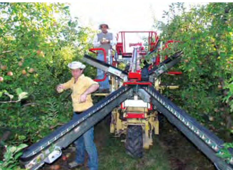
FOTO 13. Máquina Zucal, donde se observan las cintas transportadoras y los distintos niveles de trabajo.
