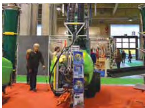
FOTO 15. Máquina pulverizadora con 3 columnas o torres de aplicación que permiten aplicar un número mayor de hileras en forma simultánea.
