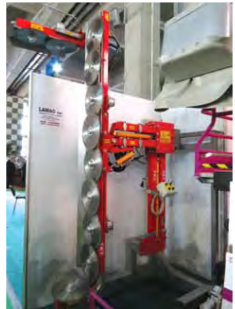
FOTO 4a y 4b. Arriba máquina podadora mecánica con barra de cuchillos en labor de poda y abajo podadora con sierras para cortes más gruesos.
