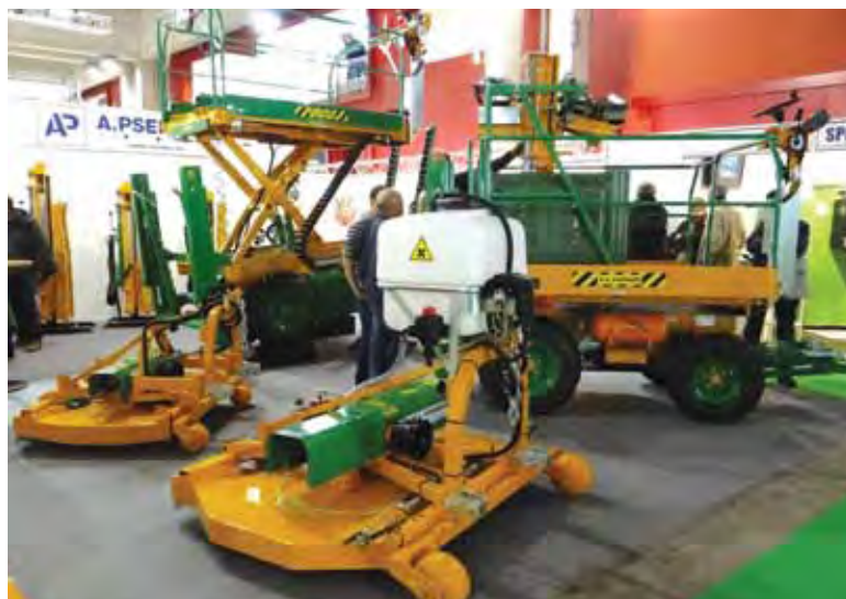
FOTO 14. Máquina central de doble propósito (cortar pasto y aplicar herbicida). Al fondo se observan diferentes modelos de plataformas.
