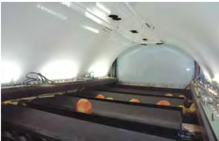
FOTO 3. Nuevo equipo selector de color. Planta Linares.
