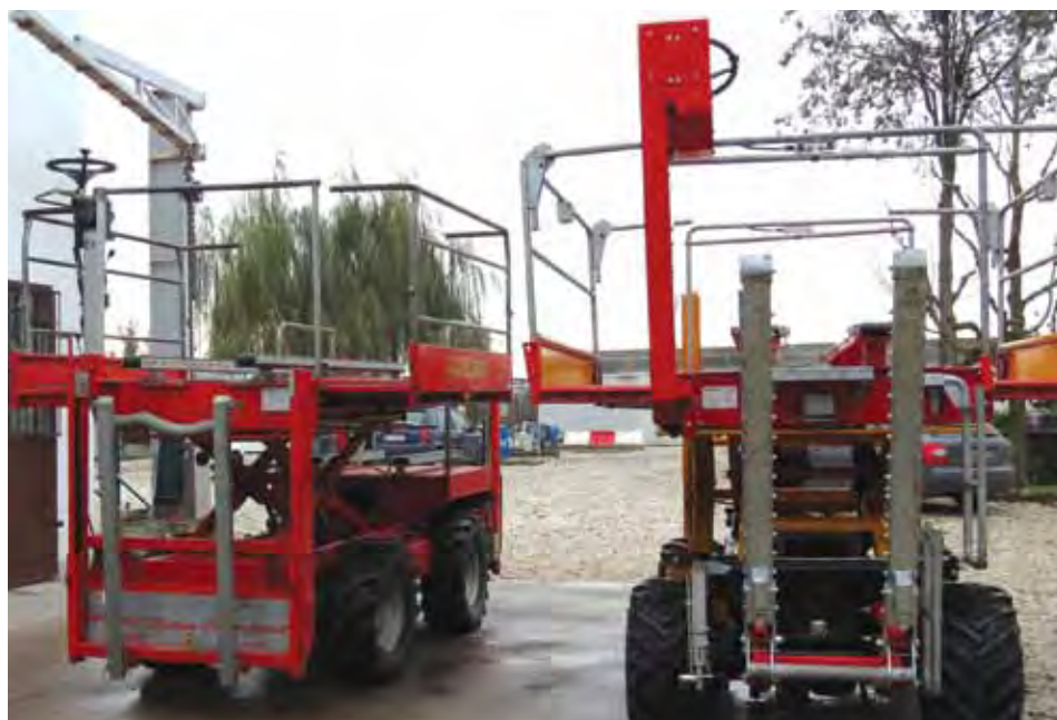
FOTO 2. Dos modelos de plataformas usadas en Europa, con desplazamiento vertical y lateral hidráulico, motor diesel y tracción en las 4 ruedas.
