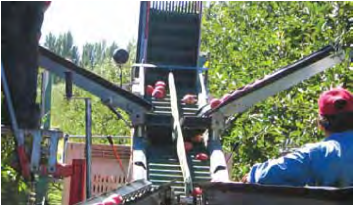
FOTO 12. Vista frontal de la Máquina Cosechadora Munckhoff Junior con sistema de cintas que conducen la fruta al llenador automático de bins.
