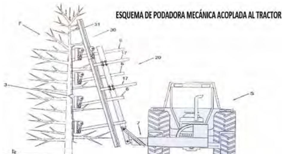
Esquema que muestra el ángulo de trabajo de 70° desde el primer piso de la máquina podadora.
