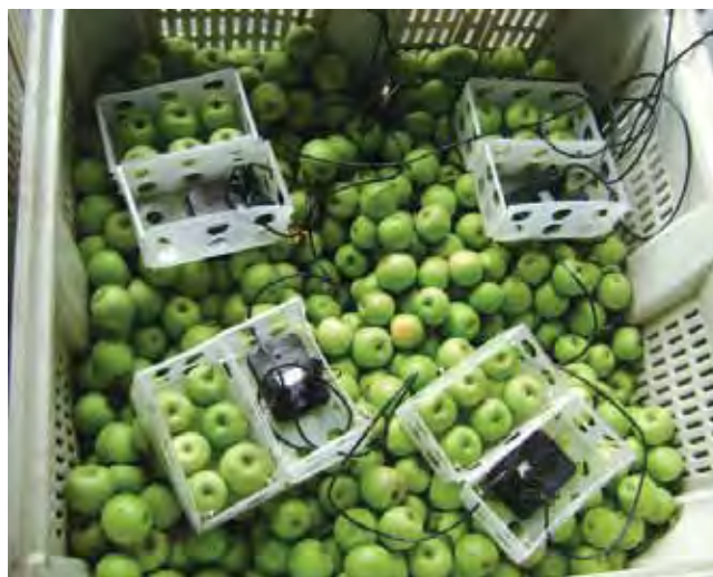
FOTO 3. Sensores de Fluorescencia.
