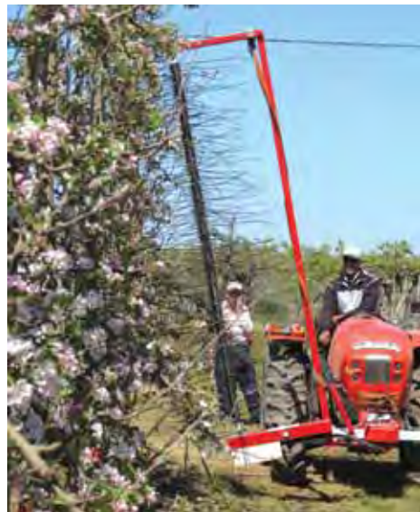
FOTO 6a y 6b. Raleadora Darwin en faena de raleo de flores en 2 tipos de huertos con conducción en muro frutal arriba y en sistema más piramidal abajo.
