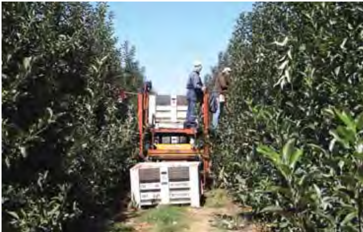
FOTO 9. Plataforma autopropulsada, en faena de cosecha directa, en un huerto de manzanos Gala Brookfield sobre M-9.
