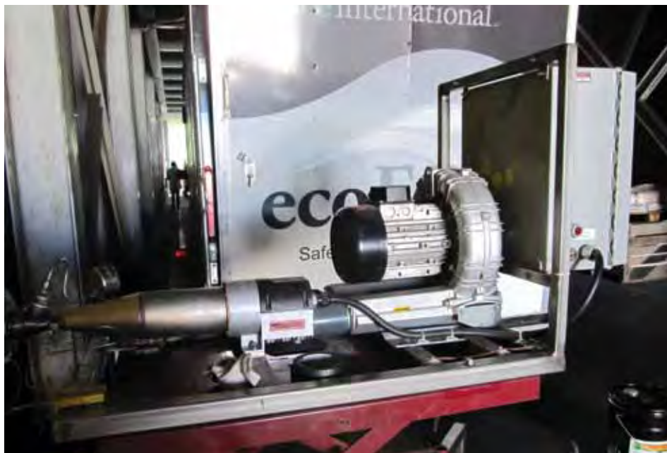
FOTO 1. Equipo Aplicador Termofogging
