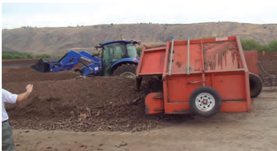
FOTO 7. Uso de máquina volteadora de compost en proyectos de gran escala.
