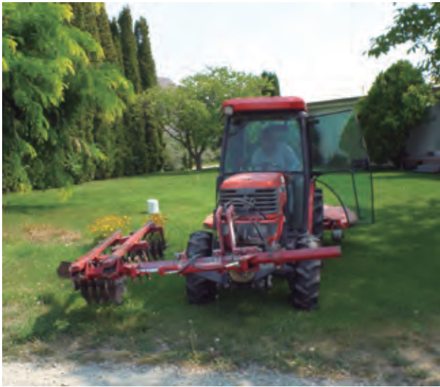
FOTOS 13 Y 14. Implemento para el control de malezas en la sobrehilera y su efecto.
