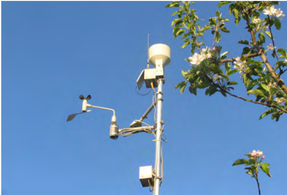
FOTO 4. Estación Meteorológica Automática.
