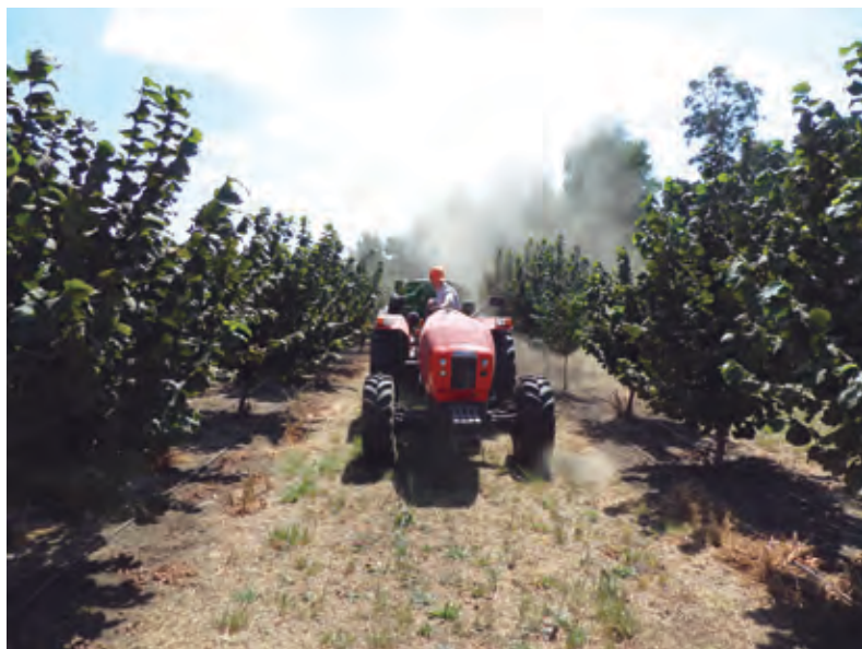
FOTO 18. Cosecha mecanizada de avellanas. Cosechadora Cimina 300 FACMA.
