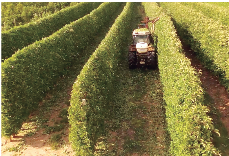
Foto 10. Poda en verde mecanizada
