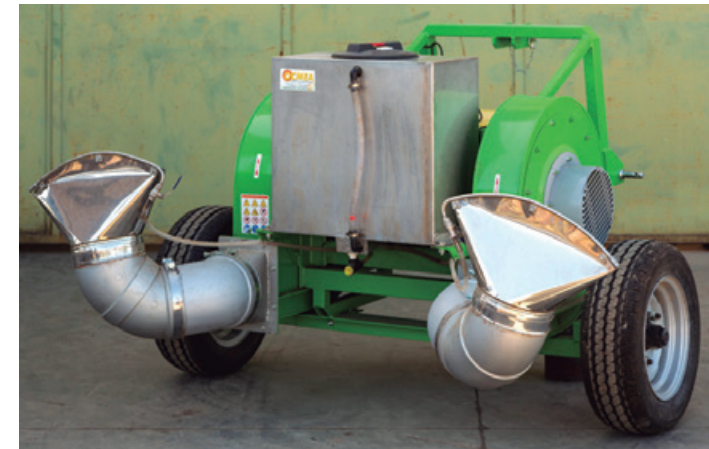
Imagen 7: Pulverizador líquido OCMEA que se conecta a tractor
