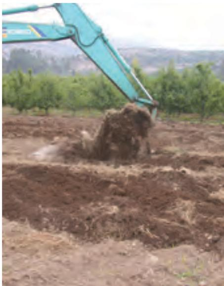
**Foto 2.** Retroexcavadora con tres puntas preparando suelo.
