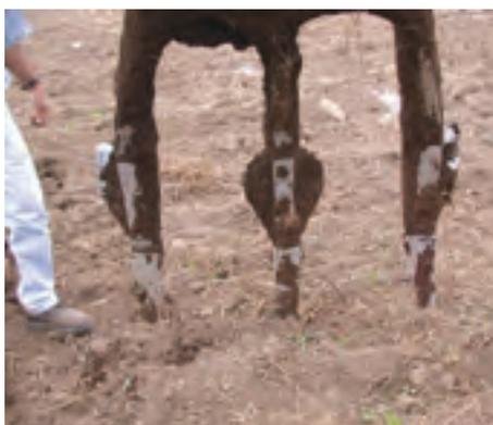
**Foto 3.** Implemento de tres puntas con aletas que permite subsolar el suelo con un ancho y profundidad efectivos de 1,2 metros por pasada.
