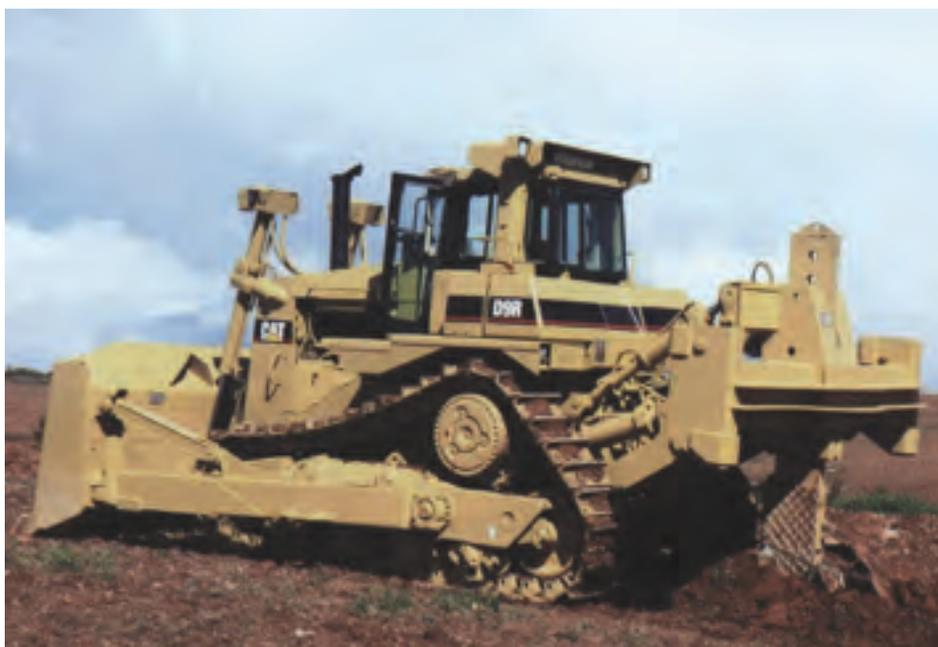
**Foto 1.** Caterpillar D9 subsolando a más de 1 m de profundidad.
