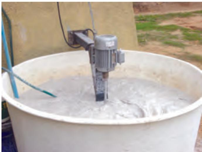
Foto 6 Agitador inyector-yeso
