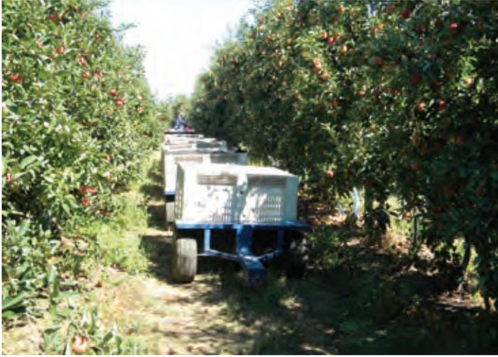
**Figura 8:** Carro portabins usado para cosecha directa de la fruta de la parte baja del árbol (Foto Huerto El Almendro, Buenos Aires de Angol).
