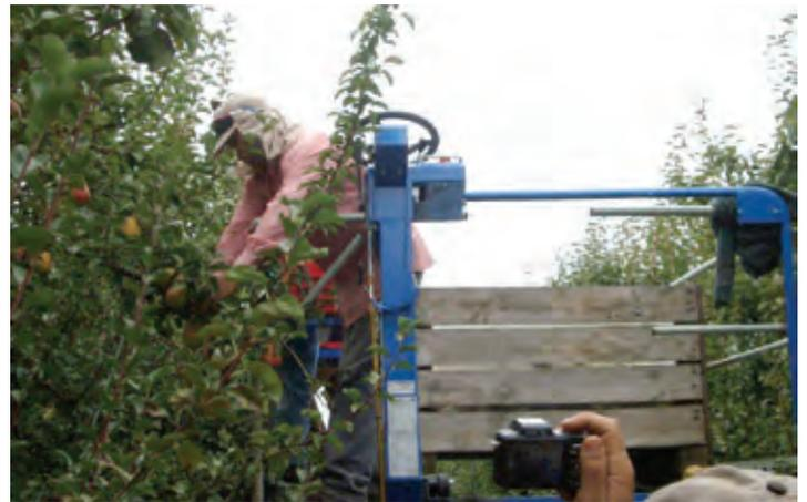
**Figura 5:** Plataformas autopropulsadas, con piso desplegado lateralmente para cosecha de la parte alta del árbol.
