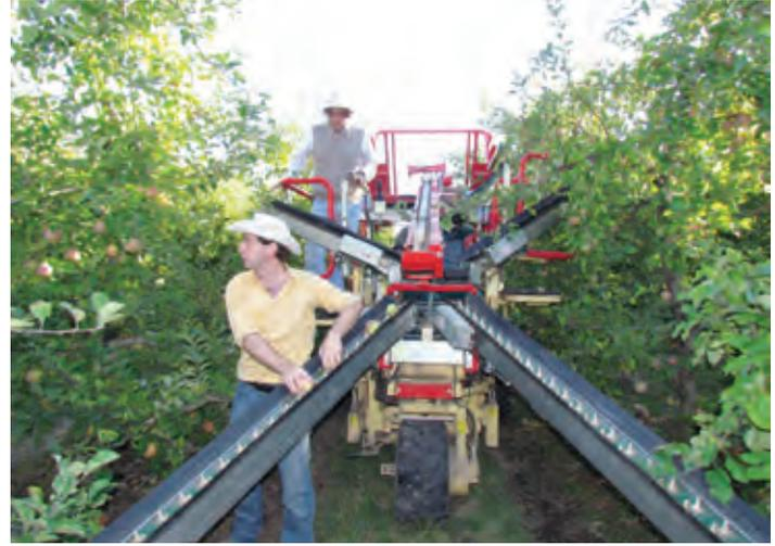
**Figura 9:** Máquina Cosechadora Zucal en faena de cosecha de manzanas.
