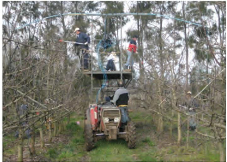
**Figura 4 a y b:** Sistema de Plataforma montada a un carro de polines, con compresor acoplado al tractor para realizar labores de poda en un huerto tradicional. (Foto huerto La Esperanza, Agrisouth Estates (Chile) S.A.).
