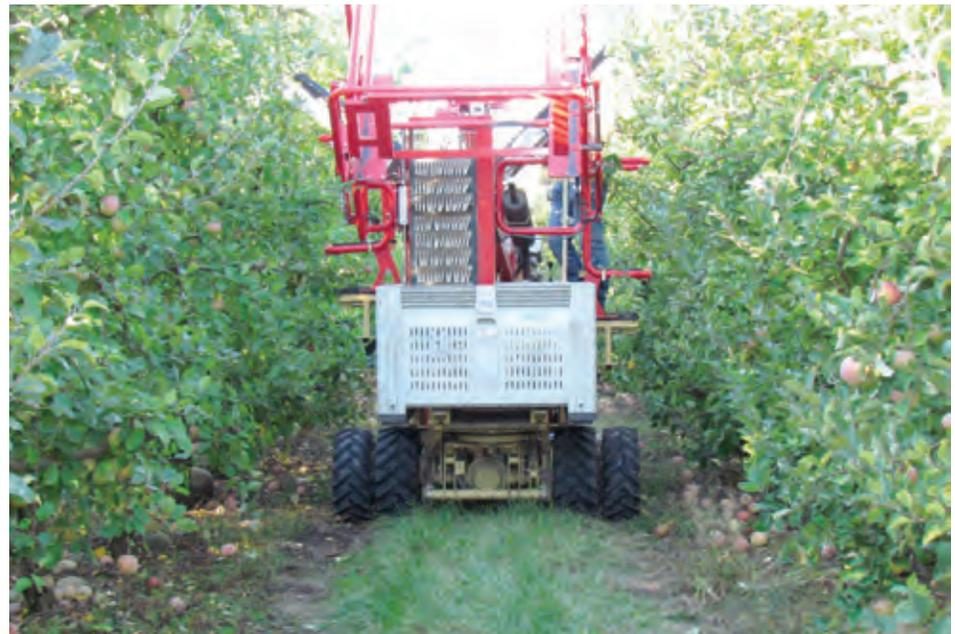
**Figura 10:** Vista posterior Máquina Zucal, donde se observa el llenador automático que deja caer lentamente la fruta dentro del bins.
