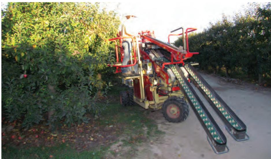
**Figura 3.** Cosechadora mecánica para manzanas.
