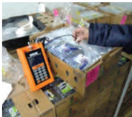
**FIGURA 2.** Medición de gases al interior de las bolsas MAP, durante en almacenaje de la fruta. Se utiliza analizador MOCON Pack-Check 325 (Minneapolis, MN, USA)
