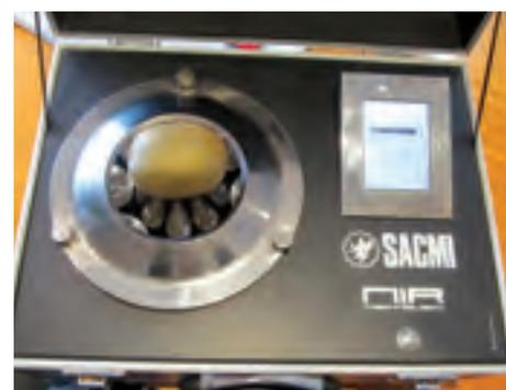
**Foto 4.** Sistema No destructivo para medición de Materia seca en kiwis.
