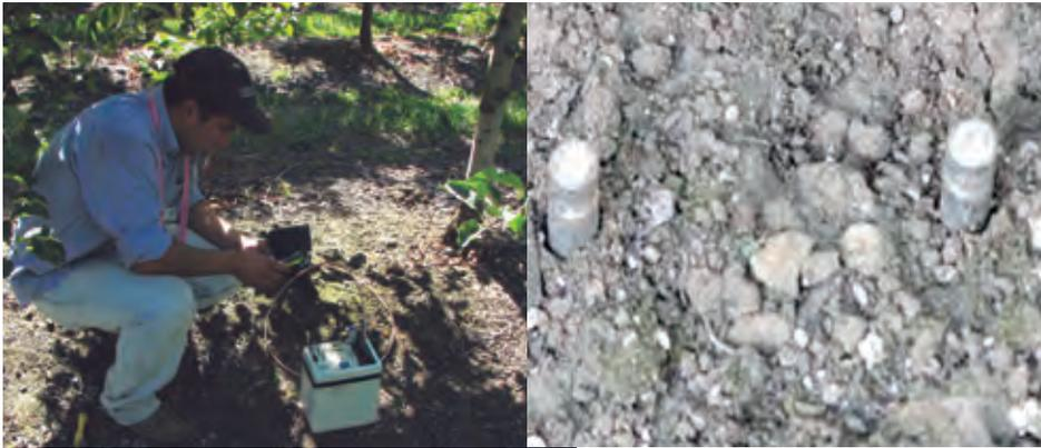
FIGURA 2. Medición del contenido de agua en el suelo usando TDR.
