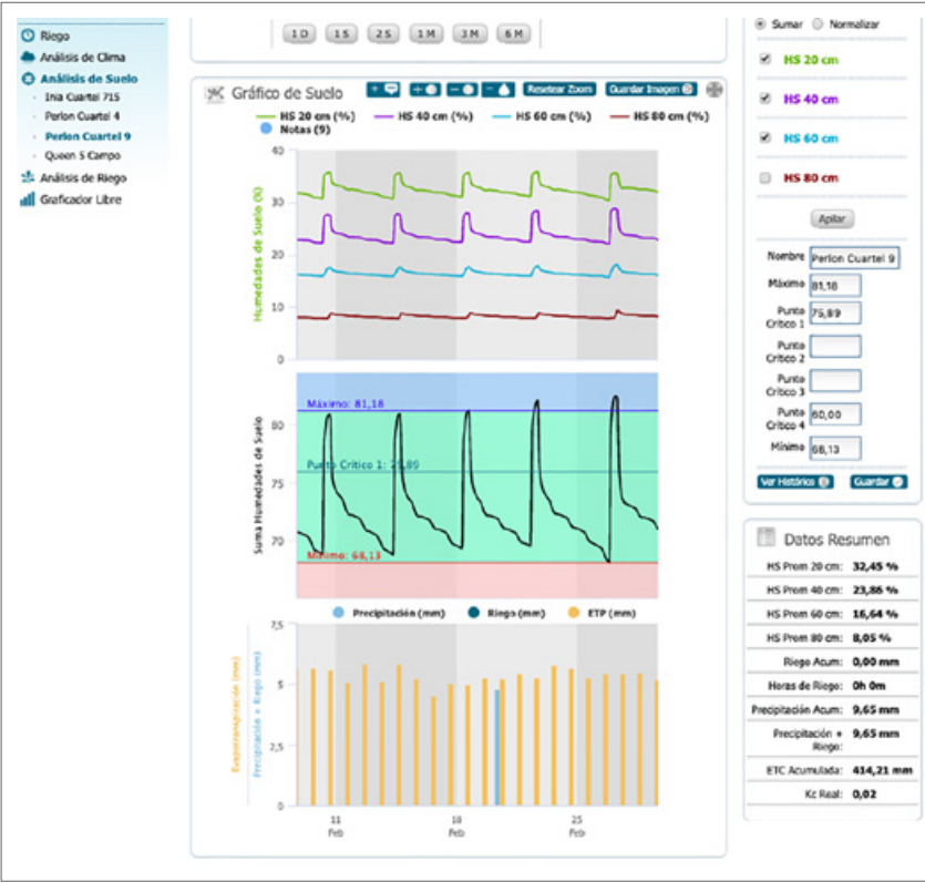
Figura 1. Actividad de las raíces registrada por la sonda de capacitancia de lectura continua y visualizada en plataforma
