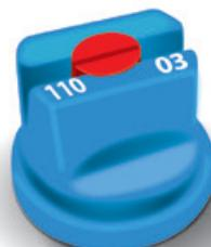
**Figura 3.** Nomenclatura estandarizada para boquillas de abanico plano. Número de la izquierda indica ángulo de apertura y el de la derecha, caudal, en galones por minuto.
