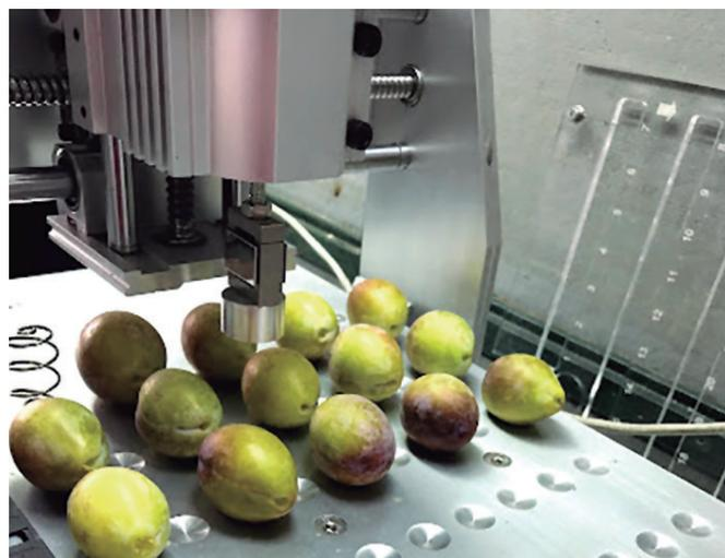
**Figura 7:** Equipo FirmPro utilizado para medir firmeza.
