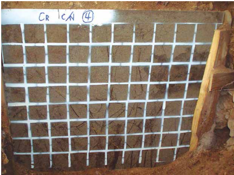
Figura 8. Rizotrones sencillos, que tomando fotografías semanales permiten construir curvas de crecimiento de raíces.
